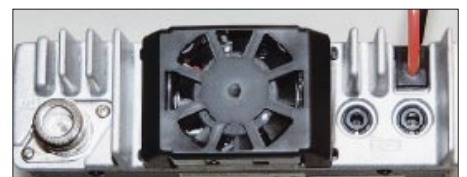
Bild 3: Ein Lüfter bestimmt die Ansicht der Rückseite, dazu die N-Buchse für die Antenne und zwei 3,5-mm-Klinkenbuchsen für Haupt- bzw. Subband-Lautsprecher.
