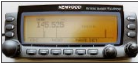
Bild 7: Das Spektrumdisplay umfaßt maximal das gesamte 2-m-Band im 12,5-kHz-Raster. Ein Durchlauf in 11 s – Spitzenklasse!
