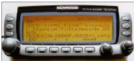
Bild 8: Packet-Radio »PnP« klappt, auch im KISS -Modus, Tx-Delay bis herab zu 7, voll DAMA -fähig und sogar PACSAT (PR via Satellit) ist möglich!
